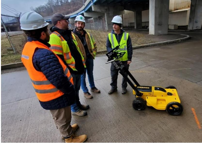
Figure 49: IDS GeoRadar DS2000 system
